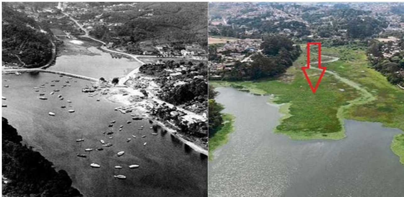
Figura 2: Assoreamento do braço da Represa Billings - Parque Linear em Eldorado – Fonte: https://www.dgabc.com.br/Noticia/3952693/frente-se-une-para-recuperar-area-da-billings-em-diadema
