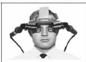
Figura 1.4. Head-mounted display desenvolvido por Ivan Sutherland. Fonte: <http://www.sun.com/960710/feature3/ivan.html>
