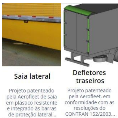
Figura 30 - Defletores laterais e traseiros adaptados à legislação brasileira
