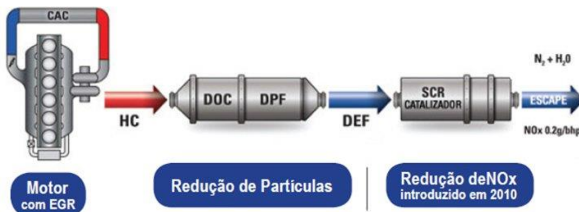
Figura 34 - Sistemas de Tratamento pós queima em motor com EGR e SCR
